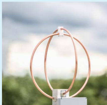
Gemessen und angegeben werden Blitzentladungen in der Maßeinheit Kiloampere (kA). Das Blitzortungssystem von UBIMET mit seiner patentierten 3D-Technologie unterscheidet zusätzlich zwischen Wolke-Wolke- und Wolke-Boden-Blitzen. Beim Wolkenblitz findet die Entladung innerhalb einer Wolke oder zwischen zwei Wolken statt. Der Wolke-Boden-Blitz entsteht hingegen zwischen der Erdoberfläche und der Wolkenunterseite. ⚡
